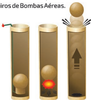
A CARGA DE PROJEÇÃO APENAS ARREMESSA
